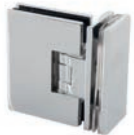
NY1-092 SANDAN SAMA YAN PANEL YAYI - ПРУЖИНА БОКОВОЙ ПАНЕЛИ СТЕКЛО-СТЕКЛО & AYARLANABİLİR - РЕГУЛИРУЕМЫЙ Her iki tarafa 90° açılabilir - Обе стороны открываются на 90°. 6-8-10 mm cam (Çinko) - стекло (цинк)
